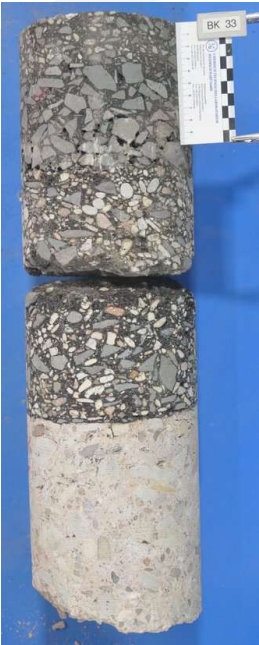
Foto des Bohrkerns
